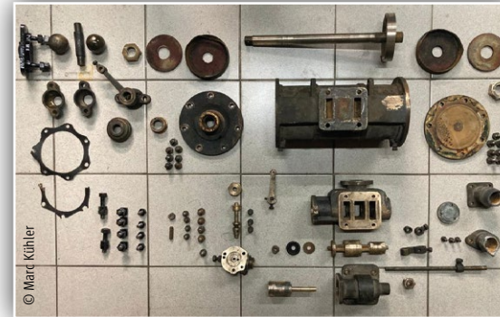
Zwecks Restaurierung wurde der Wassermotor zuerst in alle Einzelteile zerlegt.
